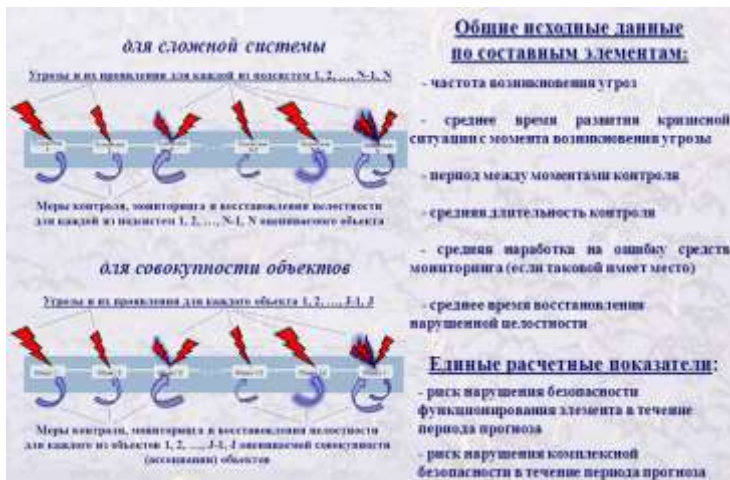
Рис. 2 Иллюстрация угроз, мер контроля, мониторинга и восстановления целостности составных подсистем оцениваемой системы
