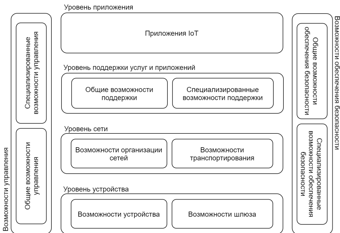
Рисунок 1. Эталонная модель IoT по рекомендации ITU-T Y.4000/Y2060.
